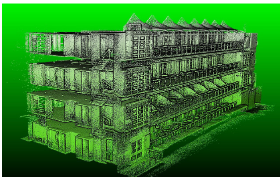
Scan eines großen Pavillonbaus mit dem ZEB-REVO in nur 30 Minuten (Datenansicht in CloudCompare)
