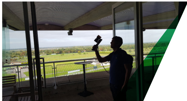
Erfassung einer großen Rennbahn in Großbritannien, die über mehr als 250 Boxen verfügt, mit dem tragbaren ZEB-REVO, Projektabschluss in weniger als 3 Wochen.
