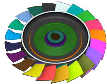
Segmentierung von CAD-Netzen
