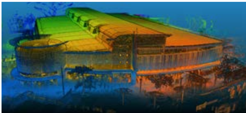
Perspektivische Ansicht eines Dachs in Singapur aus Punktwolken­daten, die mit dem ZEB-REVO 40-mal schneller als mit herkömmlichen Methoden erfasst wurden. Ansicht in CloudCompare
