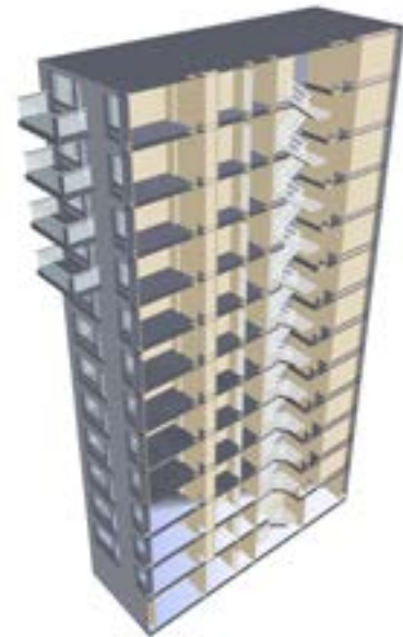
Links: Perspektivische Ansicht des Hochhauses als Punktwolke. Ansicht in CloudCompare Rechts: BIM-Modell des Hochhauses, erzeugt mit den vom ZEB-REVO erfassten 3D-Scandaten
