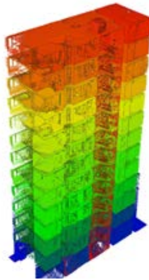
Links: Perspektivische Ansicht des Hochhauses als Punktwolke. Ansicht in CloudCompare Rechts: BIM-Modell des Hochhauses, erzeugt mit den vom ZEB-REVO erfassten 3D-Scandaten
